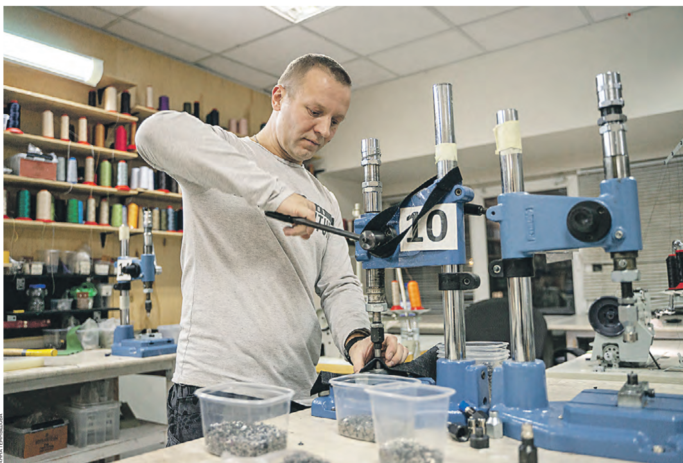
10 ноября. Начальник швейного производства Алексей Иванов не только контролирует все операции. Некоторые, когда заказов особенно много, он делает сам. Например, занимается установкой люверсов (металлических колечек) на специальном прессе
