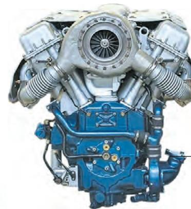
«Прорывы» используют четырехтактный V-образный дизельный двигатель В-92С2Ф. Мощность двигателя составляет 1300 л.с., удельная мощность — 27 л.с. на тонну
