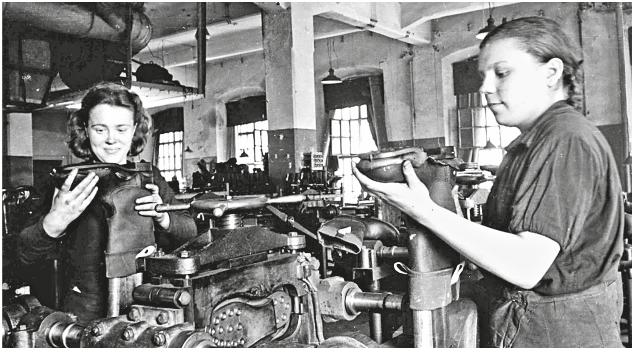
1942 год. Сотрудницы фабрики «Парижская Коммуна» за изготовлением сапог для солдат Красной армии. В годы войны предприятие внедрило метод горячей вулканизации для крепления резиновой подошвы к кирзовым сапогам, благодаря чему советские воины получили влагоустойчивую и износостойкую обувь
