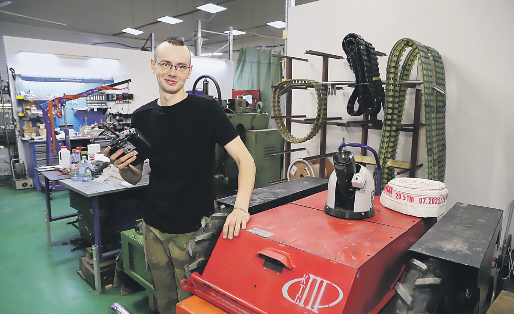
14 июля. Ведущий инженер-конструктор столичной компании-резидента ОЭЗ «Технополис Москва» Тимофей Чибрикин демонстрирует разработанный им мобильный робототехнический комплекс с лафетным стволом — водометом, предназначенный для тушения пожаров. фото: АНАТОЛИЙ ЦЫМБАЛОВ
