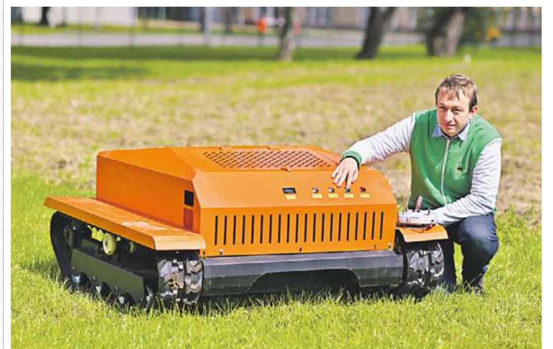
13 августа. Аспирант РГАУ-МСХА имени К. А. Тимирязева Леонид Пустобаев включает опытный образец роботизированной косилки с гусеничным механизмом. фото: ДМИТРИЙ ДУБИНСКИЙ
