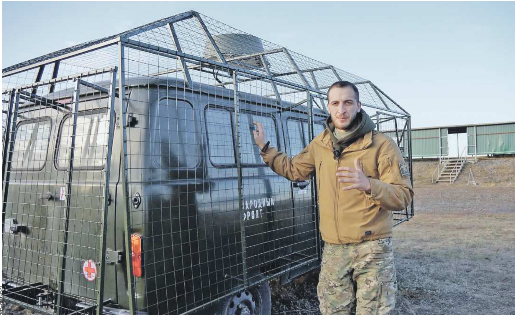
26 октября. Участник испытания обновленной эвакуационной техники, доброволец, военкор Георгий Мамсуров. В ходе теста был проверен новый комплекс защиты, который включает в себя антидроновый «мангал» и противоосколочное одеяло
