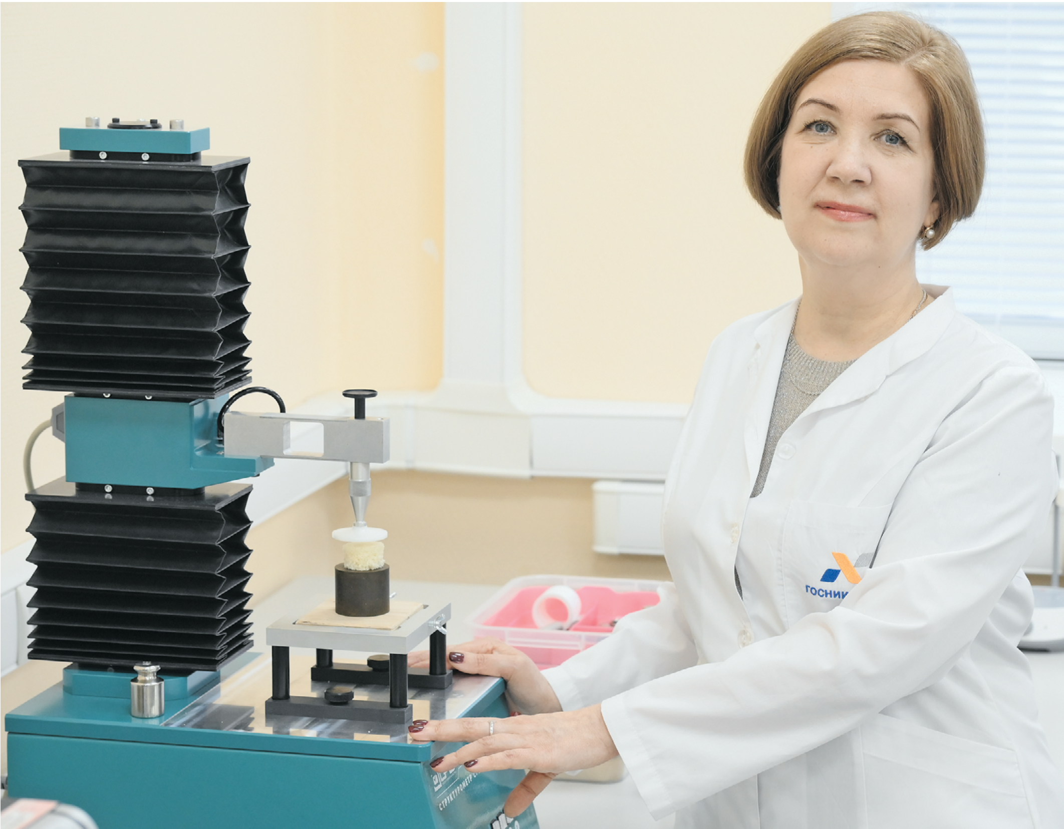
22 декабря 2025 года. Ученый секретарь НИИ хлебопекарной промышленности Ольга Тюрина у прибора, определяющего степень черствости хлеба. фото: ПЕЛАГИЯ ЗАМЯТИНА
