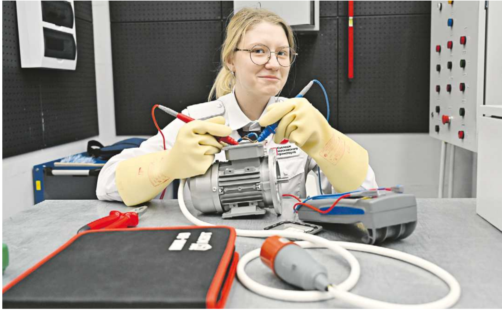
20 января. Студентка 3-го курса по специальности «Электроснабжение» Колледжа Московского транспорта Марина Гаврикова в учебной лаборатории в специальных диэлектрических перчатках измеряет сопротивление между фазами на двигателе с помощью мегаомметра. Фото: Александр Кочубей
