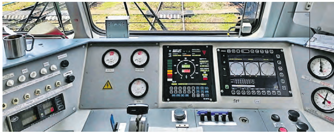
ЭВОЛЮЦИЯ КАБИНЫ МАШИНИСТА ЭЛЕКТРОВАЗА ЗЭС5К
