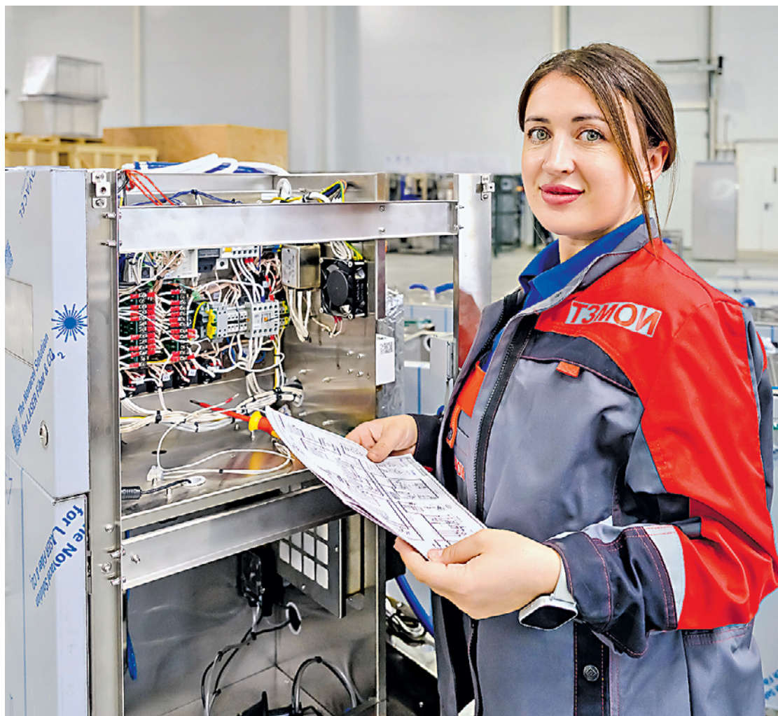
19 июня. Сотрудница предприятия по производству оборудования для инфекционного контроля, бригадир слесарей-электромонтажников Анна Прохорова за сборкой моечной машины. ФОТО: ДМИТРИЙ ДУБИНСКИЙ
