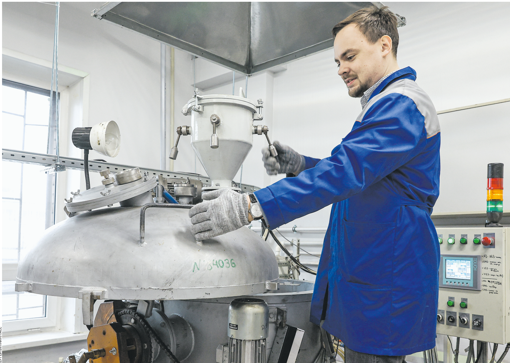
25 марта 2025 года. Начальник лаборатории металлургических процессов Виталий Санин во время подготовки к плавке сплава на основе редкоземельных металлов (лантан, церий, празеодим, неодим) в вакуумной индукционной плавильной установке на территории Государственного научно-исследовательского и проектного института редкометаллической промышленности в Москве
