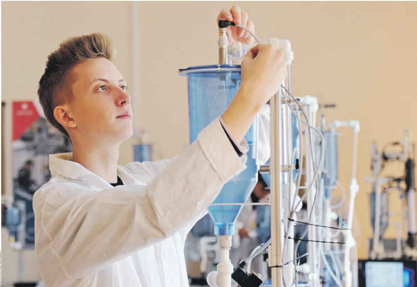
1 октября 11:28 Студент Политехнического колледжа № 8 имени дважды Героя Советского Союза И. Ф. Павлова Даниил Соболев тестирует лабораторную установку станции водоподготовки в рамках занятия по акватронике
